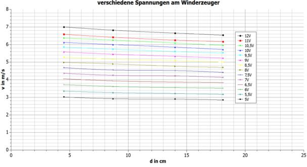
Windgeschwindigkeit in Abhängigkeit vom Abstand zwischen Winderzeuger und Windturbine für verschiedene Spannungen am Winderzeuger
